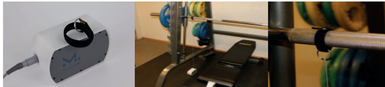
7. ábra: a Linear encoder szenzor, és rögzítése a fekvenyomás gyakorlathoz
